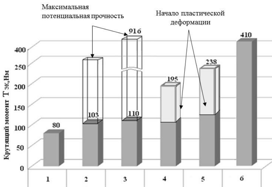
Рис. 4. Разрушающий крутящий момент для зубчатых колес из различных материалов: 1 – флубон; 2 – обработанный углепластик; 3 – углепластик без обработки; 4 – ПОМ; 5 – полиамид; 6 – сталь 45 (180 НВ)
