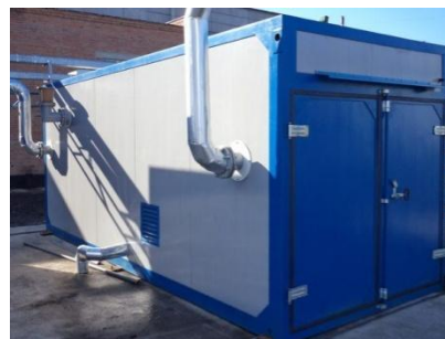
Рисунок 13 – Модуль підготовки стисненого повітря станції ААВН-40/25 У1
