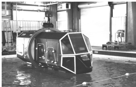
Рисунок 2 – Модульный тренажёр для отработки эвакуации
