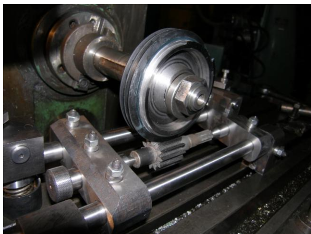
Рисунок 2 – Экспериментальная установка и процесс хонингования поверхностей зубьев шестерни модулем m = 2,625 мм
