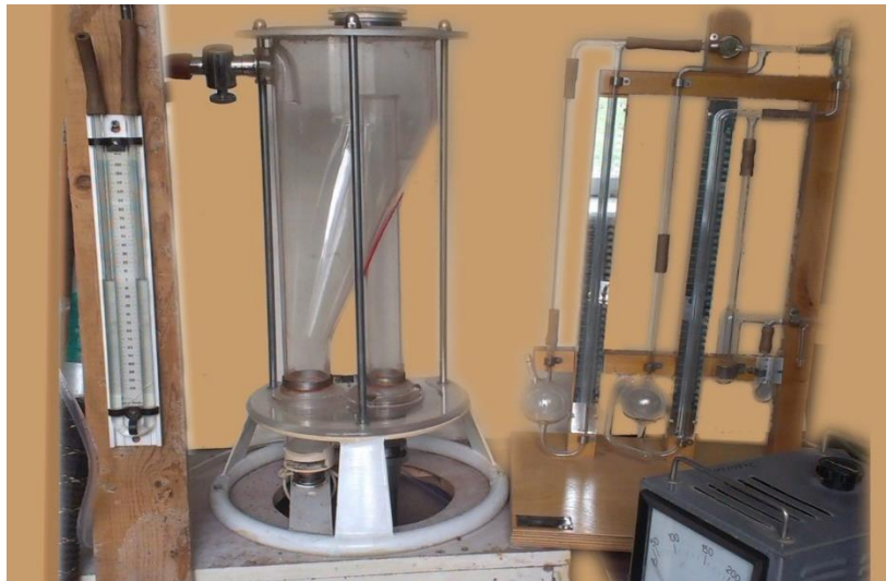
Рис. 2. Експериментальна установка для дослідження швидкості витання
